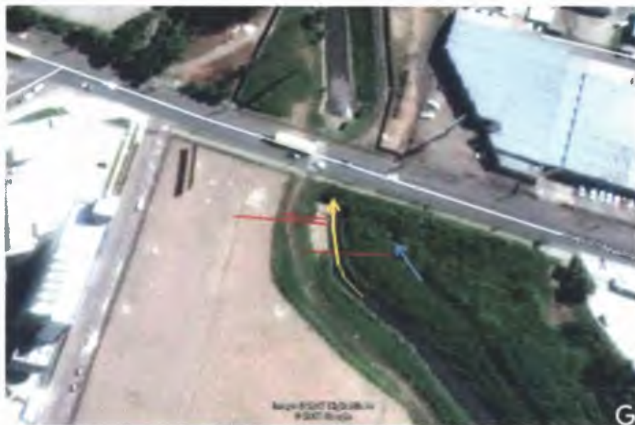
← Curso d'água natural (desativado) → Nova trajetória criada para o curso d'água canalizado
